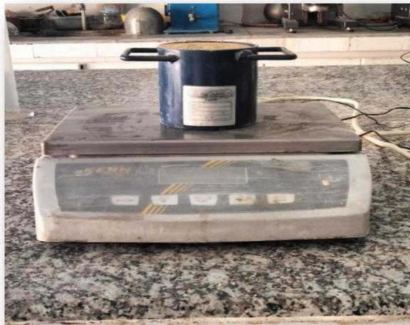
*Figure II.4 : Masse volumique apparente*
