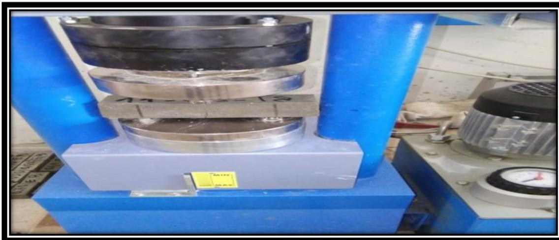
*Photo II.9 : Dispositif expérimental de l'essai de flexion*
