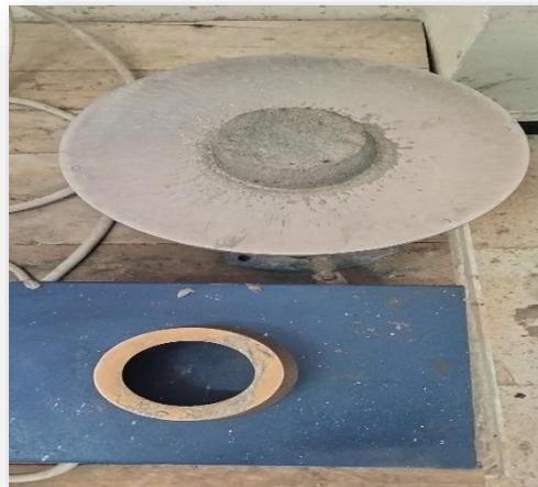
*Photo II.7 : Essai d'ouvrabilité*
