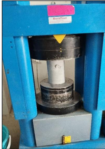
**Figure 3.6** : L'échantillon placé entre les plaques de compression de la machine d'essai.
