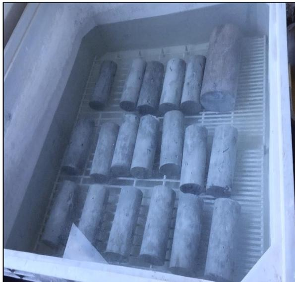
Figure 3.1 : Saturation des échantillons dans un bac d'eau.
