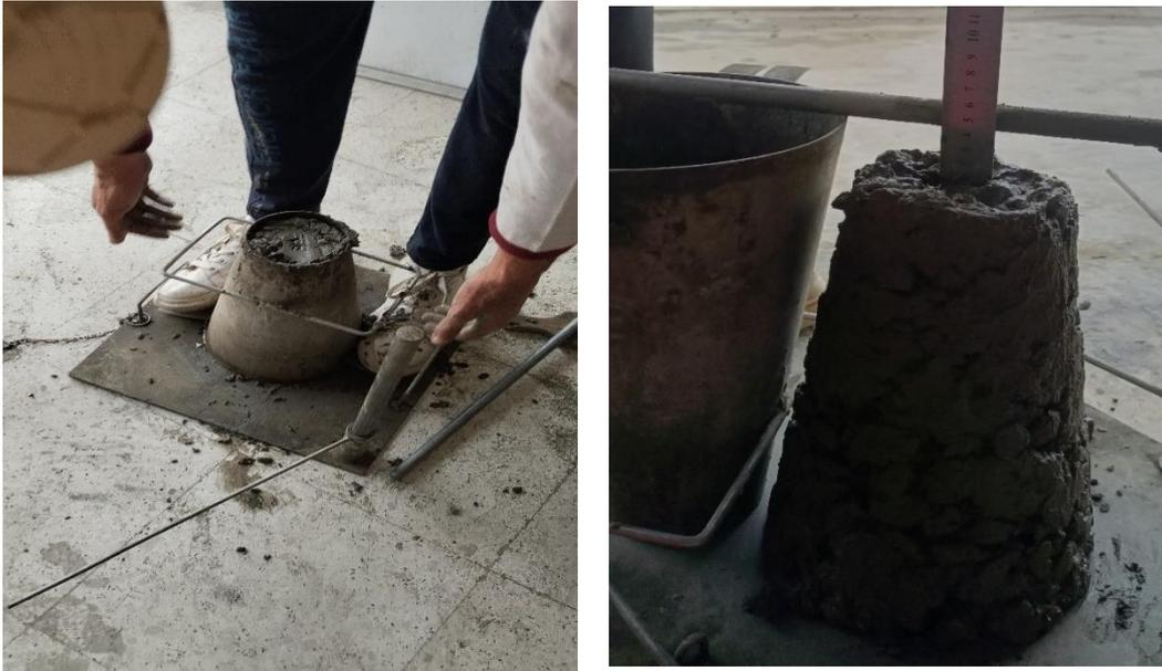
**Figure 2.6 :** Essai d'affaissement .
