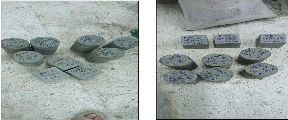
Figure 2.8 : Démoulage des éprouvettes.
