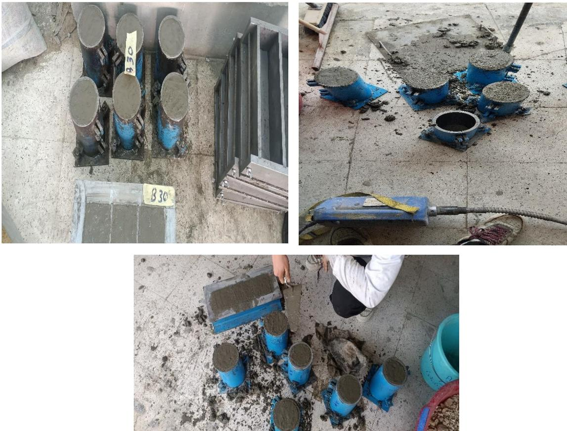
**Figure 2.7 :** Coulage et remplissage du mélange de béton dans les moules.
