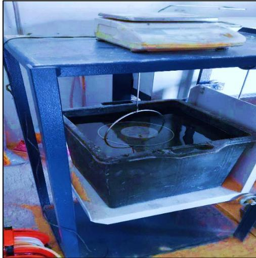
**Figure 3.2** : Balance hydrostatique pour la mesure de  $M_e$ (Masse à l'eau )
