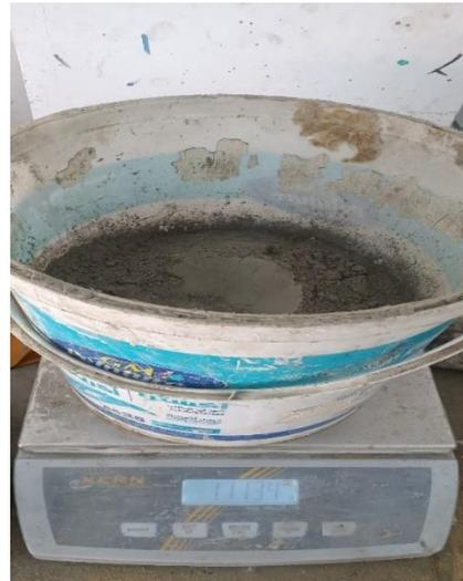
**d) Ciment****Figure 2.4 :** Pesage des quantités (ciment – eau – sable – gravier ).
