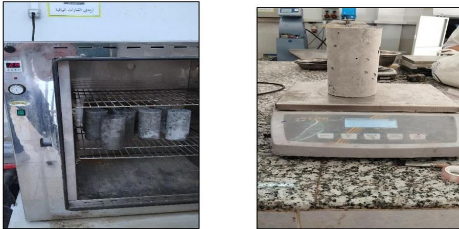
Figure 3.4 : Séchage des éprouvettes .
