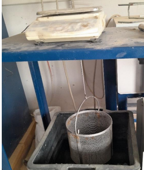
Figure 22 Essai de porosité accessible à l'eau
