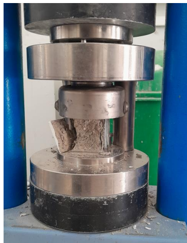
Figure 23 Essai de la résistance à la compression
