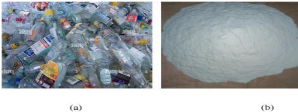
Figure 9 (a) les verres usagés tels que reçus (b) la poudre de verre recyclée
