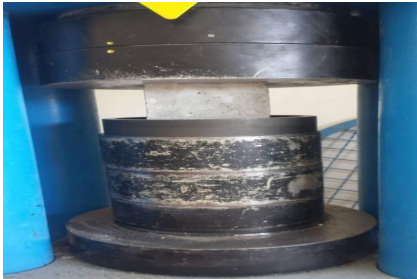
Figure II.8 : Dispositif expérimental de l'essai de compression.
