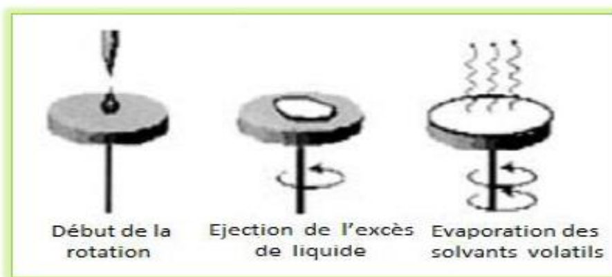
Figure I-6: Schéma représentant le principe de préparation de film mince par La méthode de tournette [4].
