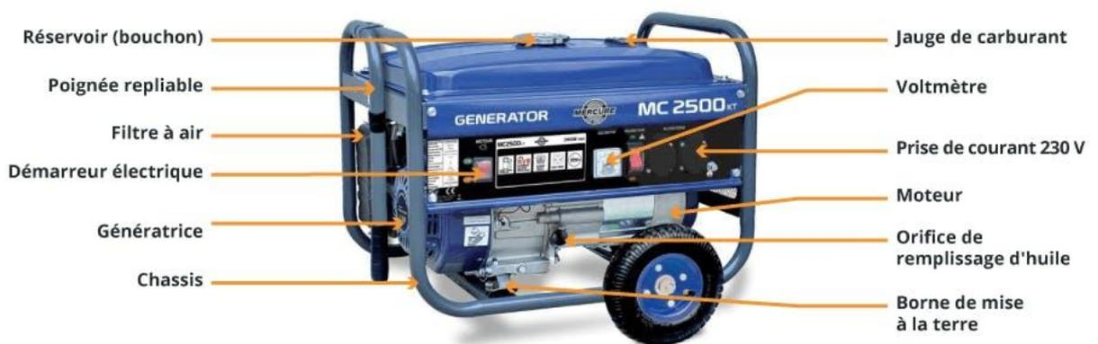
Figure I.2. Constitution d'un groupe électrogène [3].
