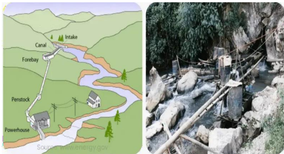
Figure I.16. Système récupération d'énergie par micro-générateur hydroélectrique [48].
