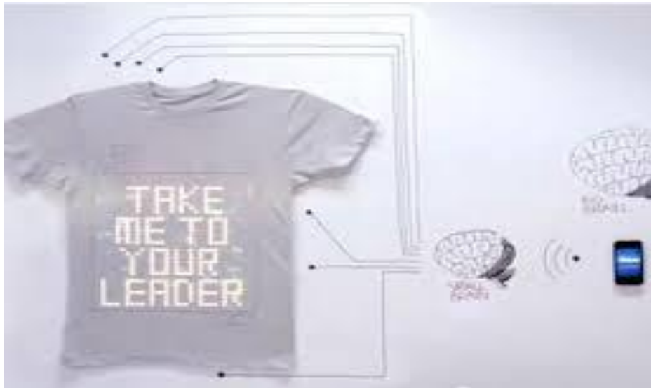
Figure II.6. T-shirt OS by Cute Circuit intégrant un écran de LED.
