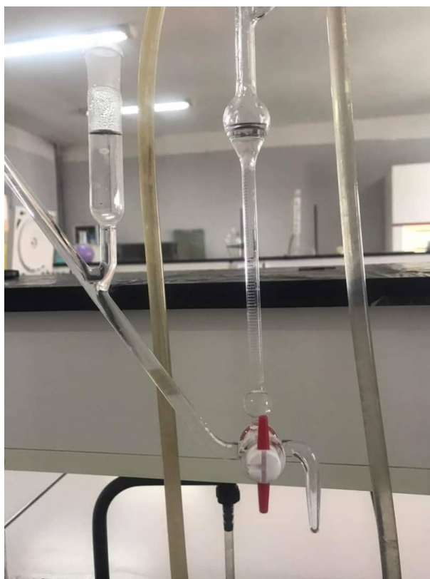
Figure 3.2: Robinet de Clevenger pour la récupération de l'huile essentielle
