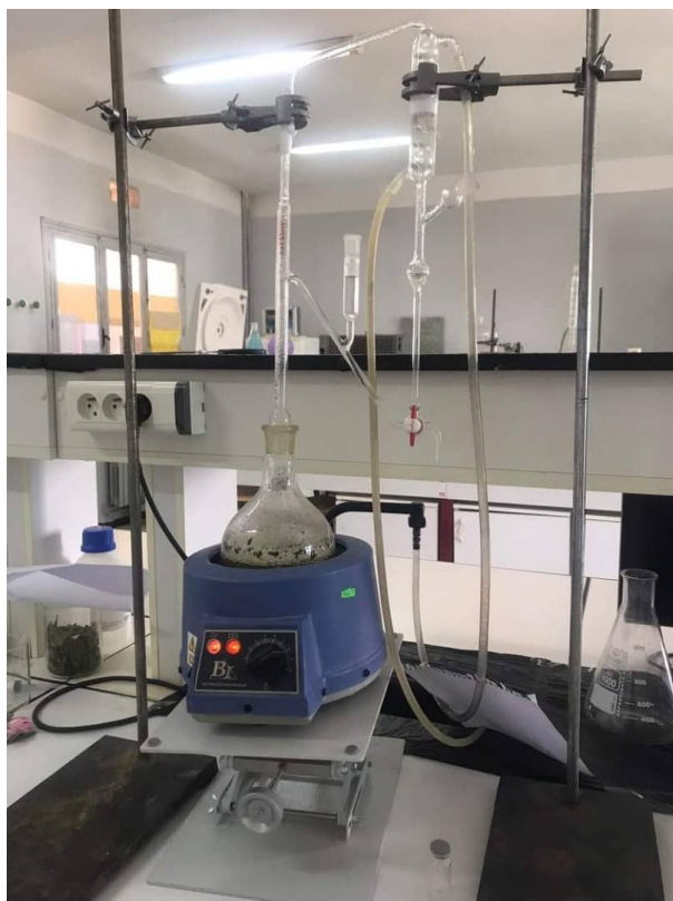
Figure 3.1: Hydrodistillation des huiles essentielles : montage de Clevenger
