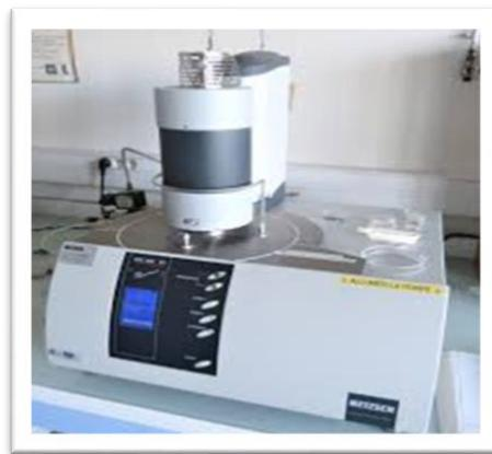
**Figure.18** : Analyse Thermogravimétrique (ATG)
