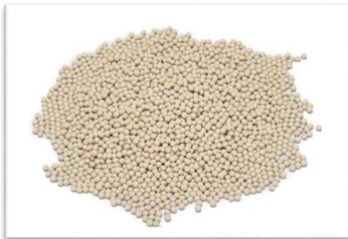
**Figure.12** : Zéolite (tamis moléculaire).
