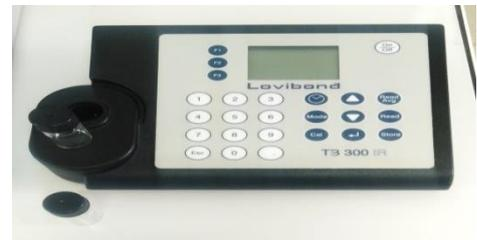
Figure IV.5: Un turbidimètre.
