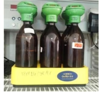
Figure IV.12: DBO mètre.
