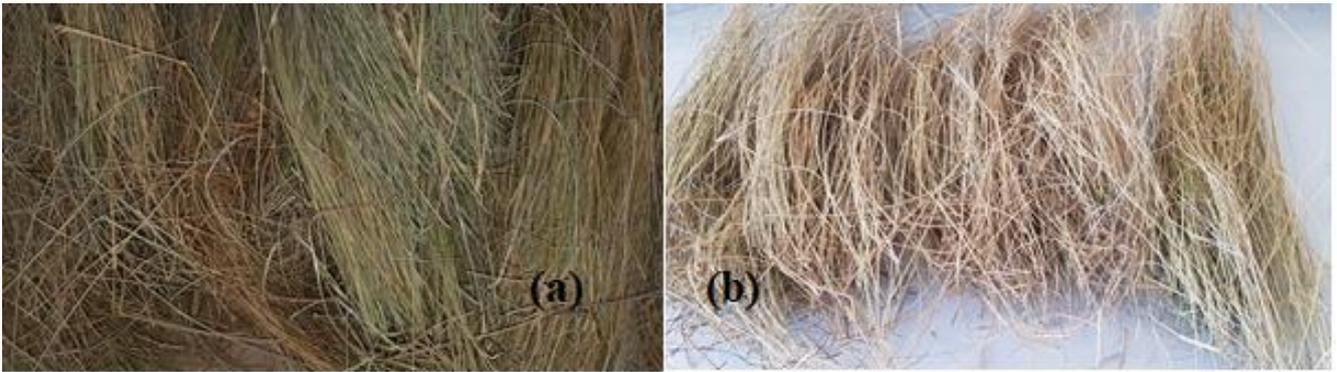
Figure II.01. Fibres d'Alfa avant le lavage (a) et après le lavage (b).
