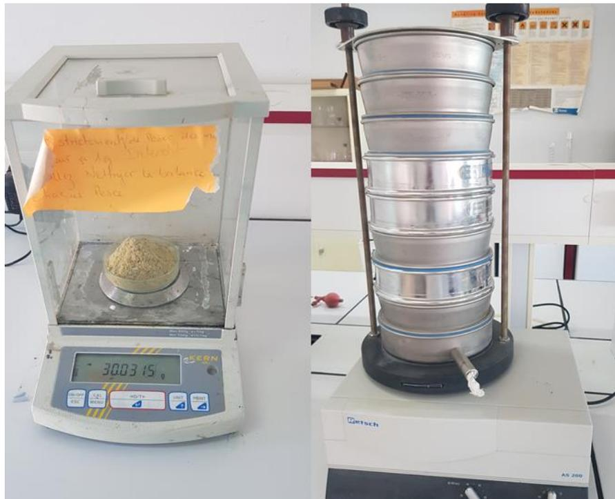
**Figure a.01 : le processus de l'analyse granulométrique (balance analytique + tamiseur vibreur).**
