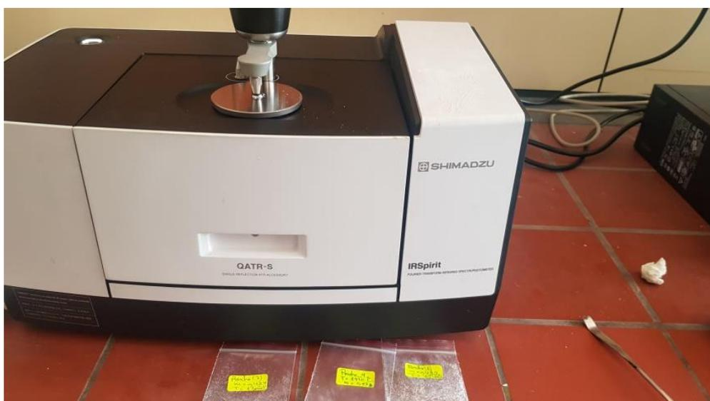
**Figure a.03 :** La spectroscopie infrarouge à transformée de Fourier (FTIR) shimatzu.
