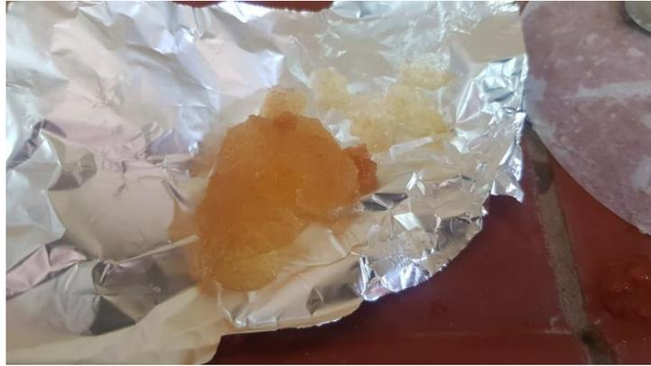
Figure III-15. L'état de super absorbant après une saturation a **pH=12**.
