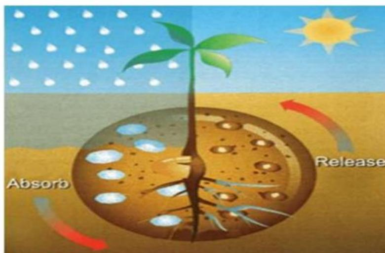
Figure I-21 : mécanisme d'hydrogel d'absorption et libération d'eau [51].
