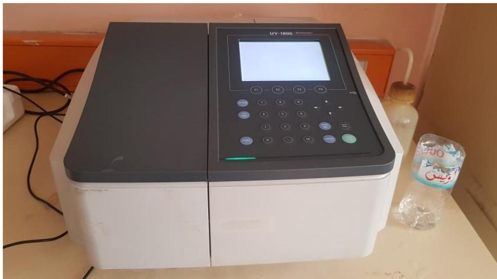
**Figure a.02 :** spectrophotométrie UV-Visible shimatzu UV-1800.
