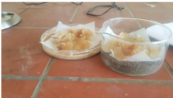
**Figure II.14.** La représentation de l'hydrogel sur deux types du sole (sableuse et argileuse).
