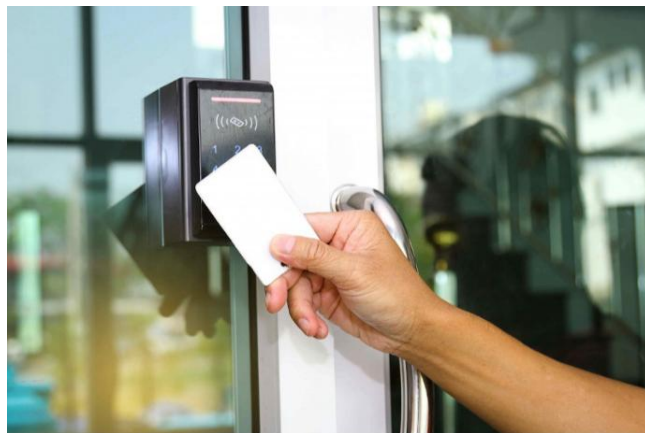
FIGURE 1.12 – Authentification d'accès par badges d'accès [30]
