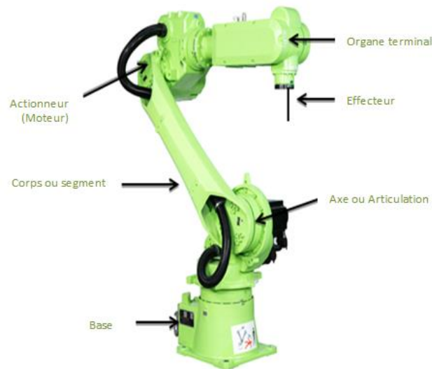
Figure I. 4 : Vocabulaire d'un bras manipulateur.
