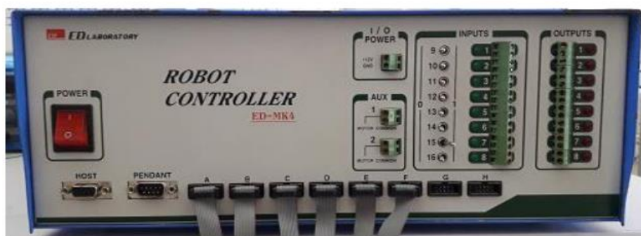
Figure II. 5 : L'unité de contrôle ED-MK4.
