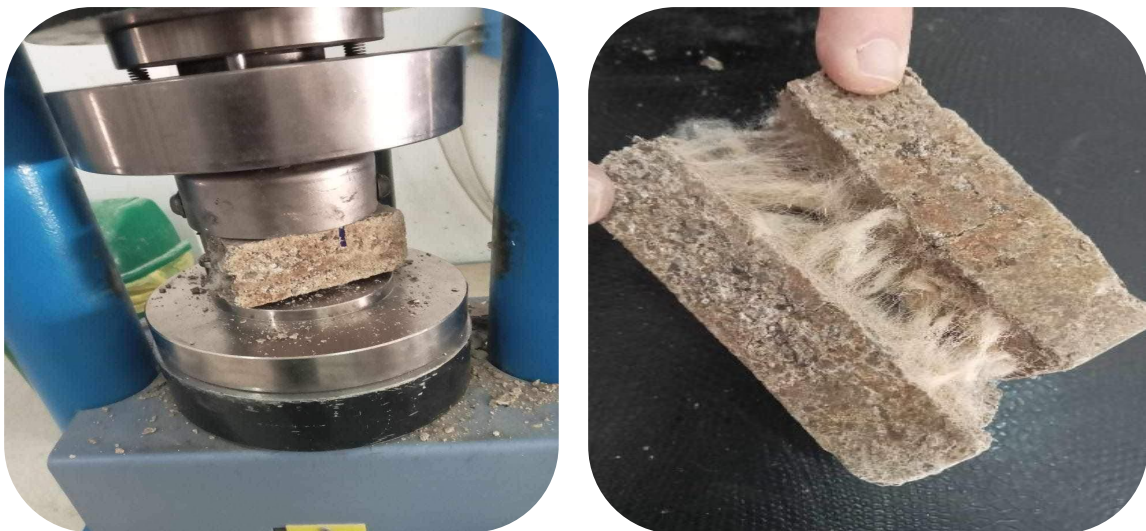
Figure 3. 16 Rupture d'échantillon du BTC par compression
