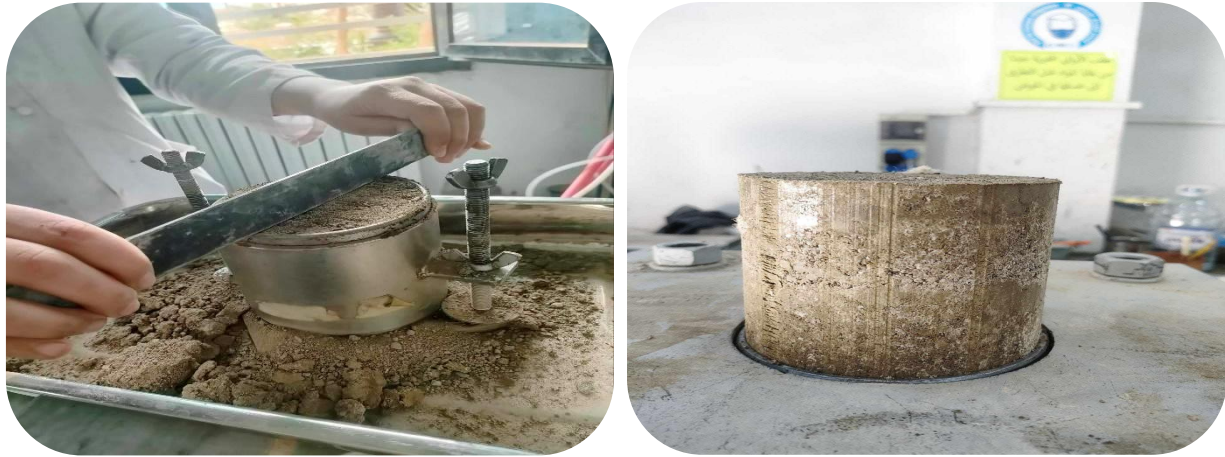
Figure 2.8 Travail expérimental de l'essai Proctor normale.
