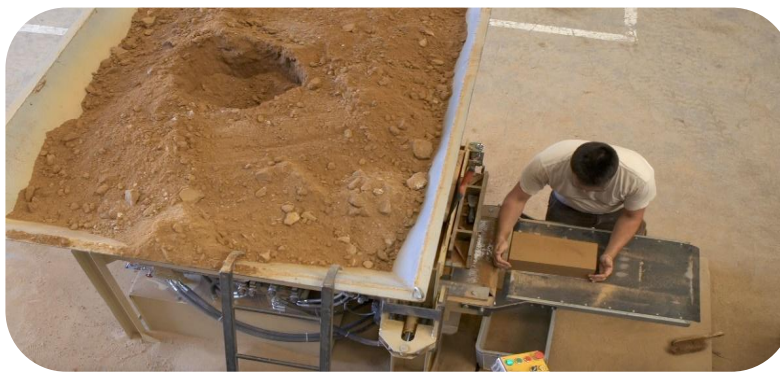
Figure 1.11 Méthode de fabrication du BTC [1].
