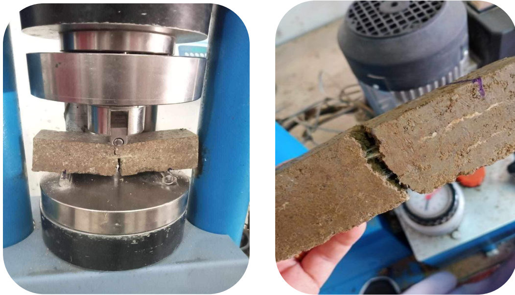
Figure 3.17 Rupture d'échantillon du BTC par flexion
