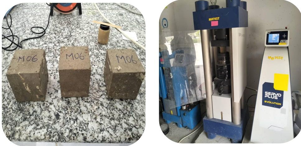
Figure 3.14 Presse utilisé pour déterminer la résistance à la compression
