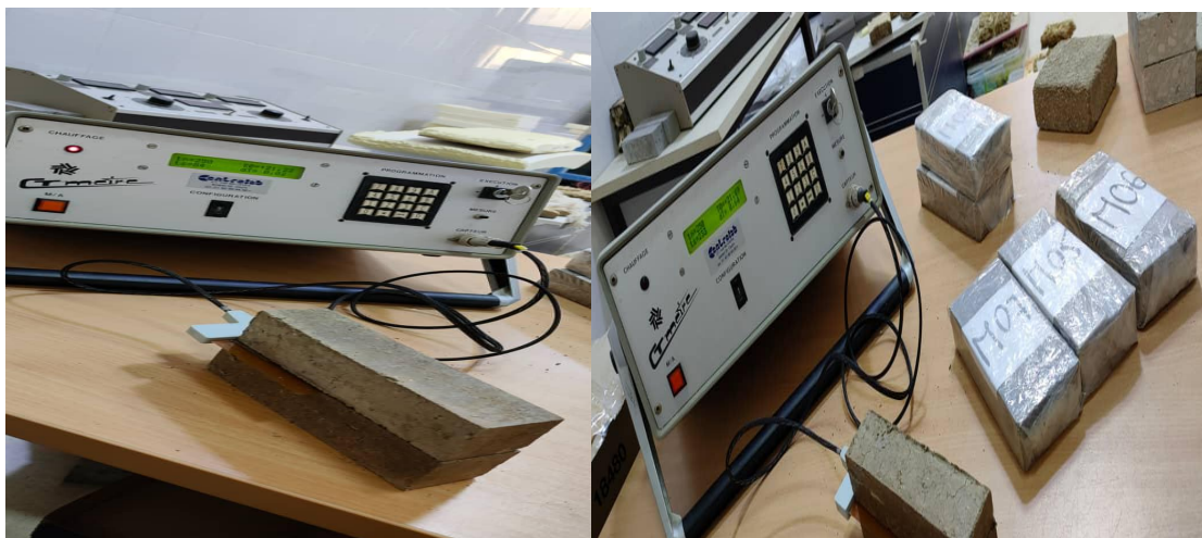
Figure 3.28 Chauffage utilisé pour mesurer la conductivité thermique.
