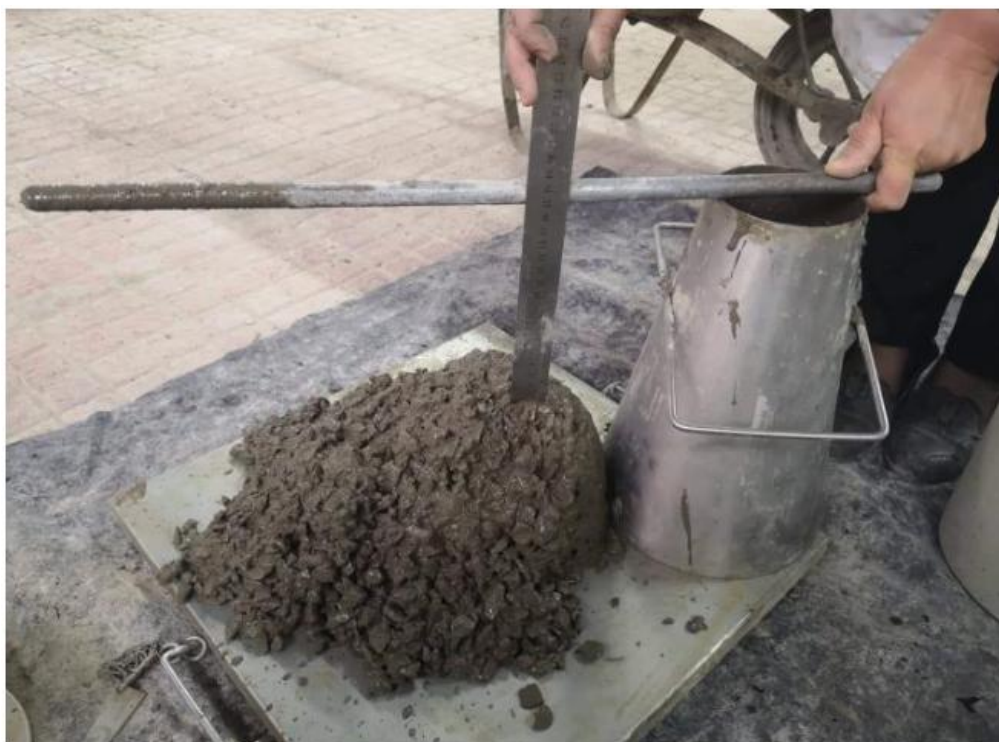
Figure 22 Essai d'affaissement con d'Abrams
