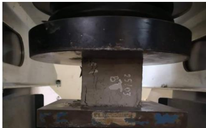
Figure 27 Epreuve au cours d'écrasement.
