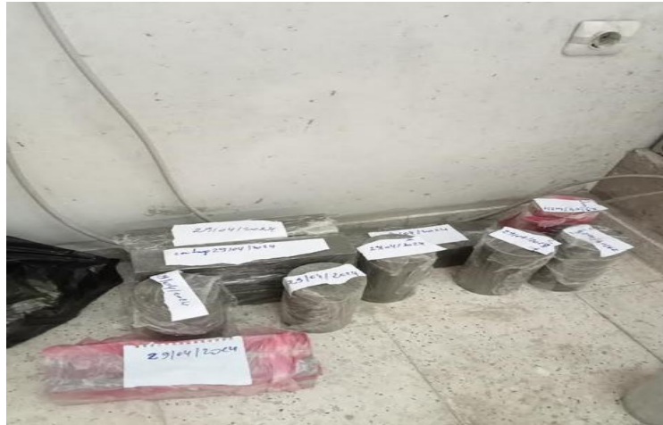
Figure 26 Les Epreuves après 24h de coulage
