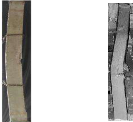
Figure III.3- Flambement des poteaux mixtes :
