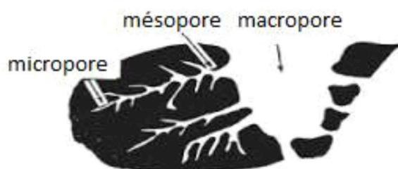
**Figure II. 6:** Représentation de la texture poreuse d'un charbon actif.
