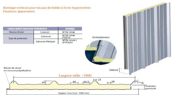
Figure 3.16: détail de panneau sandwich (bardage).
