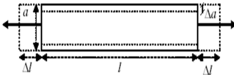
Figure I.4.: Déformations dans une section droite d'une poutre.
