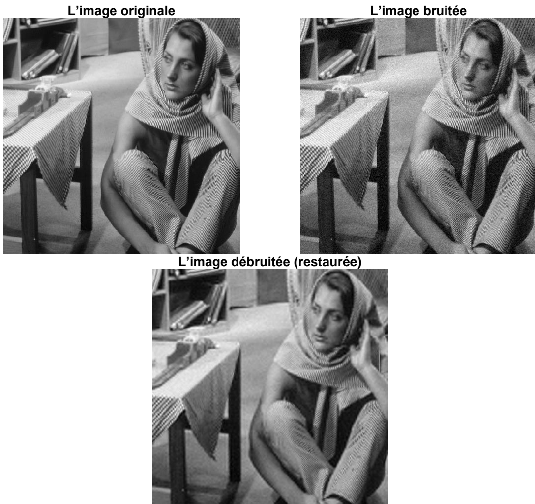
Figure 2.5 : L'image Barbara est dégradée par l'addition d'un bruit blanc Gaussien et débruitée dans le domaine des ondelettes.
