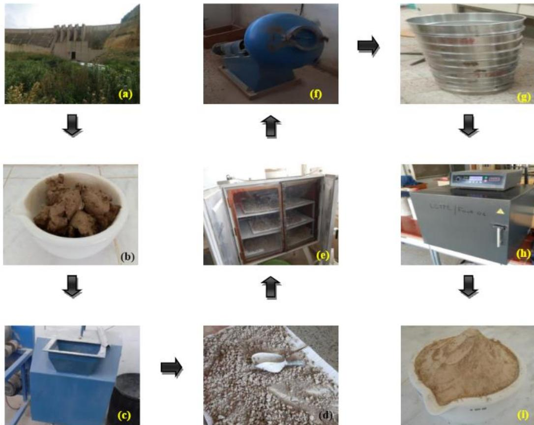
Figure 14: Etapes de préparation de la vase calcinée de barrage : (a) Extraction, (b) La vase à l'état humide(c,d) Calibrage 25mm, (e) Etuve à 105°C, (f) Broyage, (g) Tamisage 80  $\mu\text{m}$ , (h) Traitement thermique 750°C pendant 5heures
