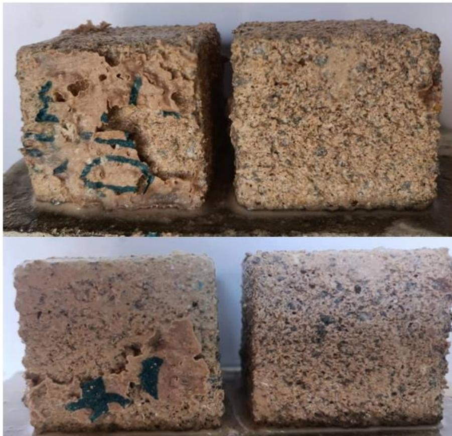
Figure 33: Echantillons dégradés après immersion à H<sub>2</sub>SO<sub>4</sub>
