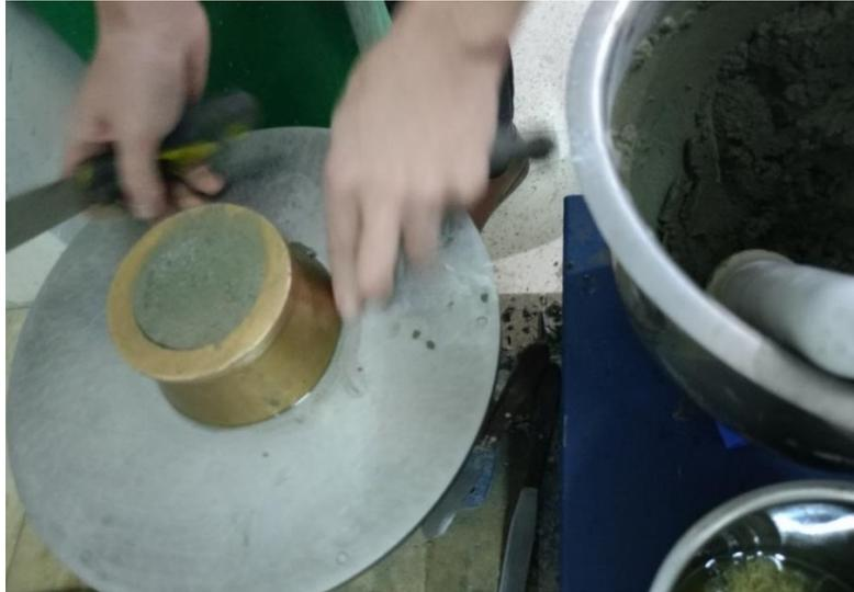
Figure 21: Mesure d'étalement
