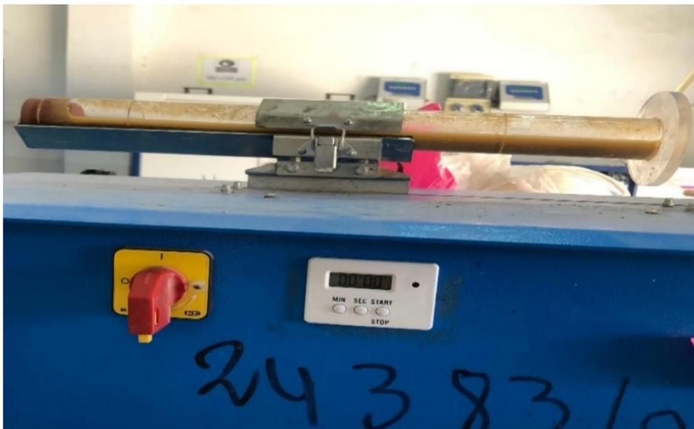
Figure 20: l'essai d'équivalent de sable (labo génie civil)
