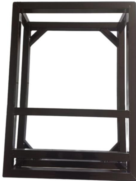
Figure. 3.1. Structure du châssis après soudure et revêtement.
