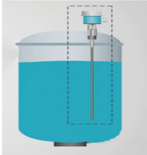
Figure. 1.6. Méthode de mesure par sonde capacitive [2].
