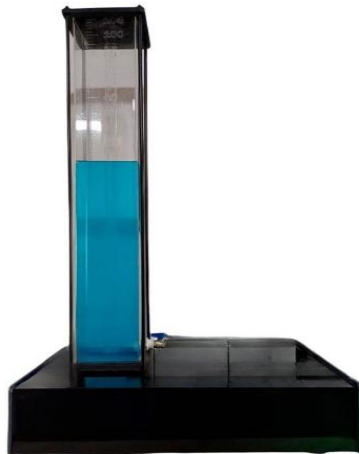
Figure. 3.4. Montage du réservoir sur le prototype.
