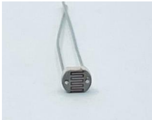
Figure III.12. La photorésistance ou LDR [45]
