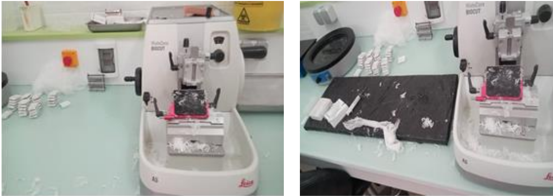
Photo 04 : Réalisation des coupes à l'aide d'un microtome (Originale)
