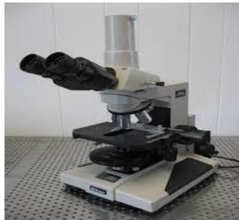
Photo 7 : Microscope optique (Optica) (Originale)
