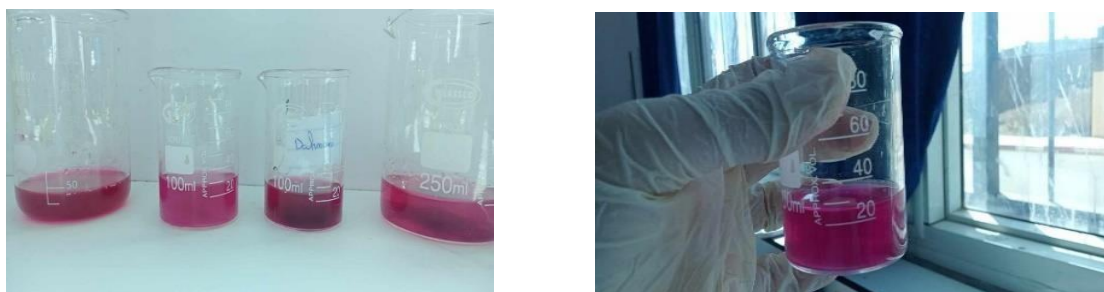
Figure 07: dosage de calcium dans l'eau analysée
