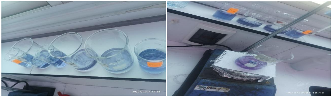
Figure 08 : dosage de magnésium dans l'eau analysée
