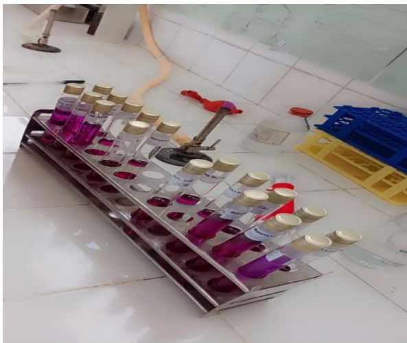
Figure 09 : la recherche des Coliformes Totaux et Coliformes Fécaux dans l'eau analysée
