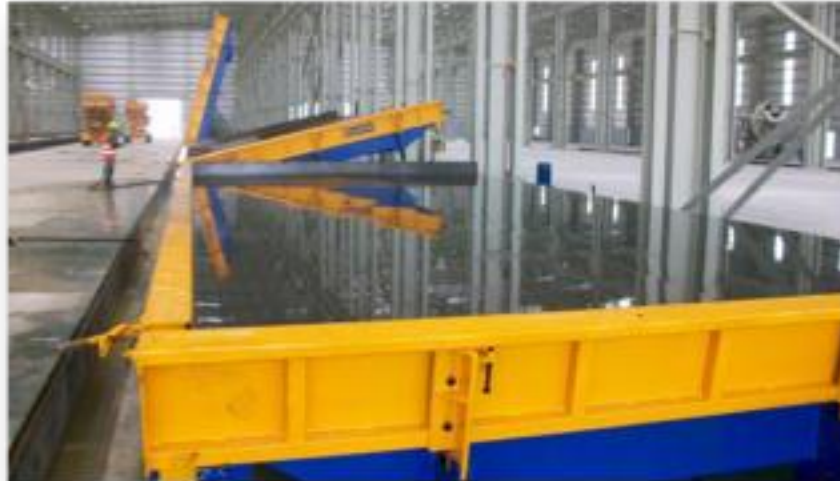
Figure 6.2. Table basculant position de coulage.
