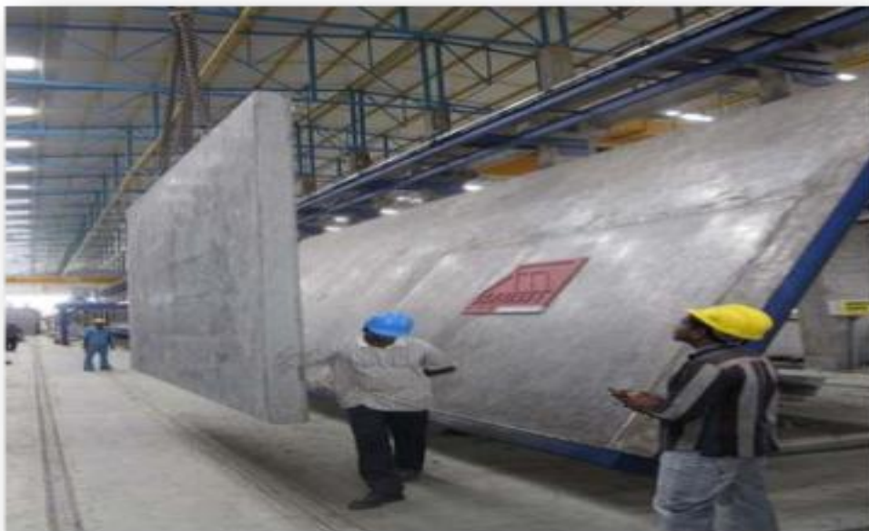
Figure 6.3. Table basculant position de levage.
