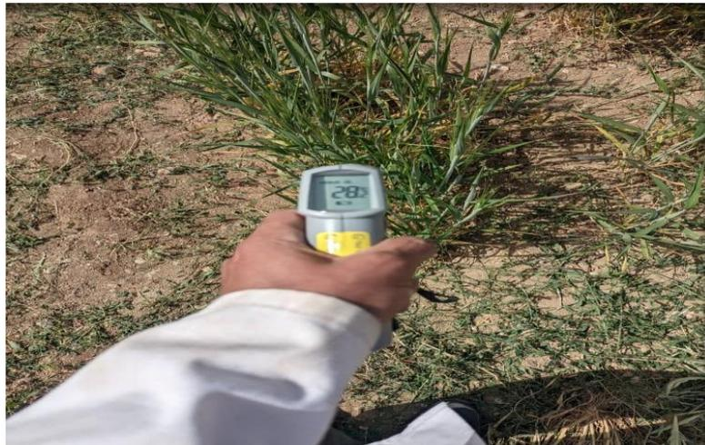
**Photo 3 :** Mesure de la température du couvert végétal à l'aide d'un thermomètre à infrarouge portable chez les génotypes de blé étudiés.
