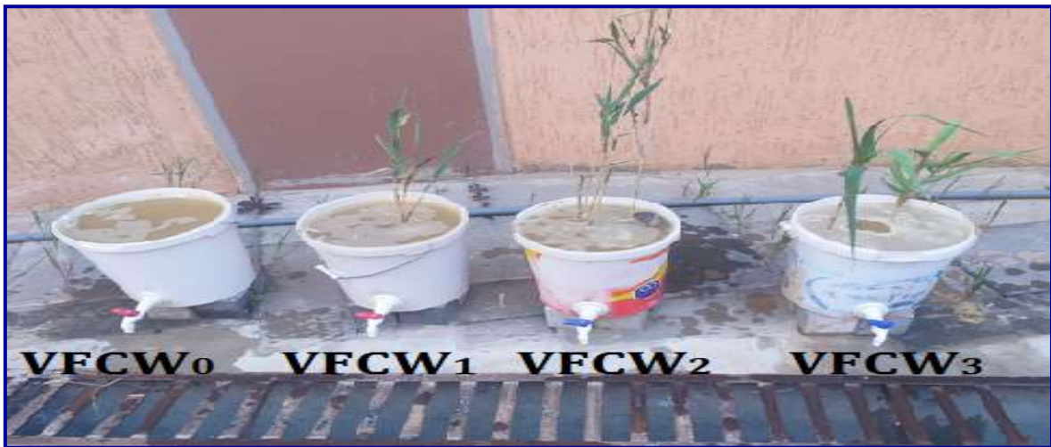
Figure 2 | Vue de l'installation VFCWS à l'échelle expérimentale
