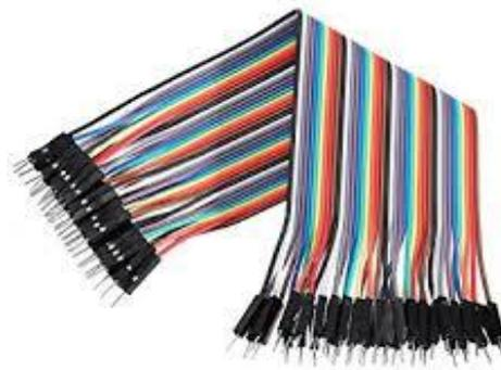
Figure III 6 : Les câbles de bronchement.[4]
