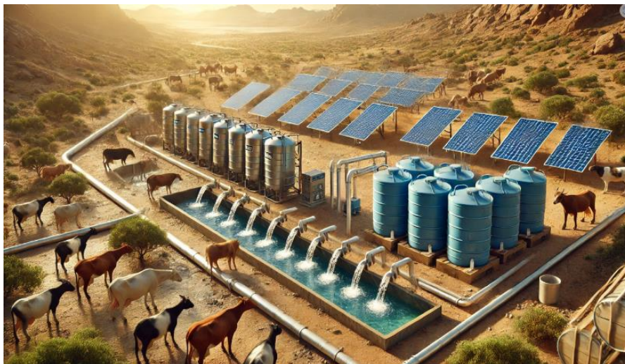
Figure 2-3 Système de pompage solaire approvisionnant un abreuvoir pour animaux.
