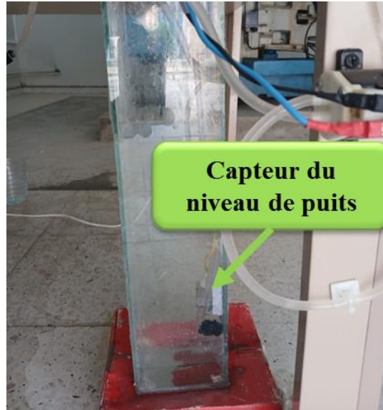
Figure 3-11 Capteurs du niveau de puits.
