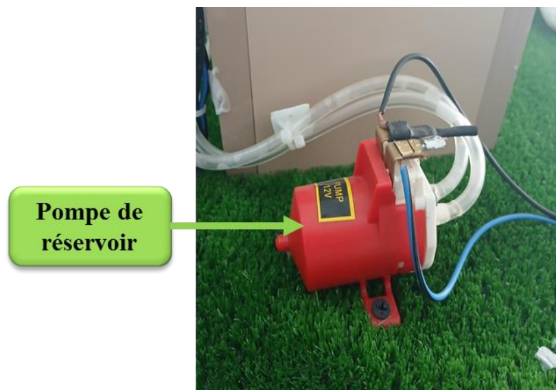
Figure 3-15 Pompe de réservoir.
