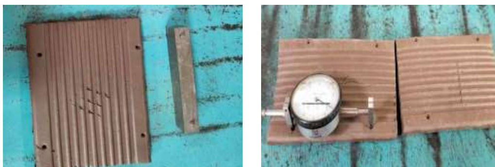
Figure II.9 : Retrait de brique avant et après séchage
