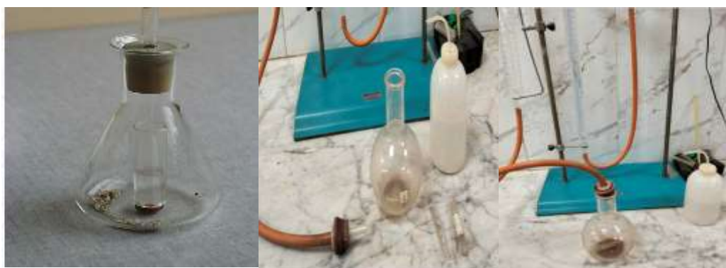
Figure II.12 : Collecte de CO 2 pour déterminer la teneur de CaCO 3 .
