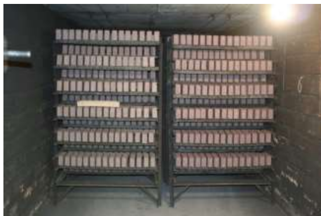
Figure I.18 : Séchoir à chambres
