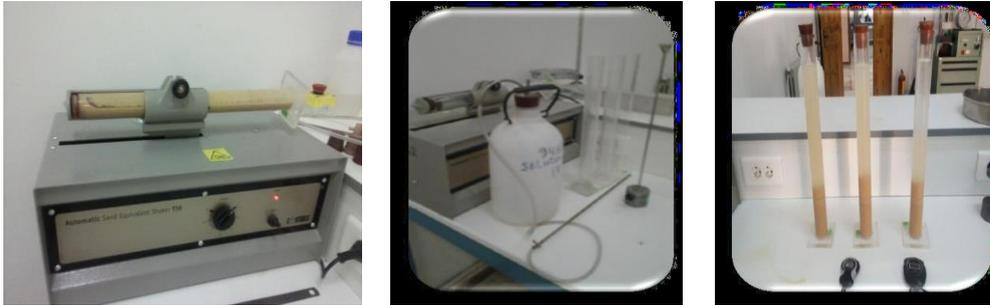
**Fig4. 4 : Appareillage et matériels utilisés pour l'équivalent de sable**
