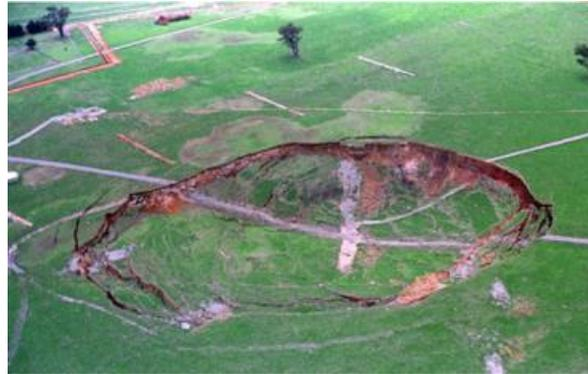
**Fig1. 3 : Affaissement du terrain survenu sur la mine d'Elura située l'ouest-nord-ouest de Sydney, en Australie**
