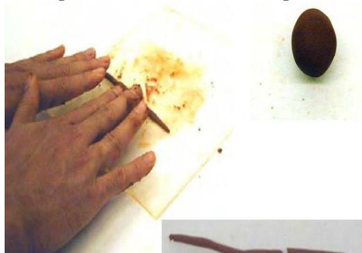
Fig4. 9 : Détermination de la limite de plasticité
