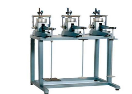
Fig4. 14 : Banc d'Oedomètre à charges frontal.
