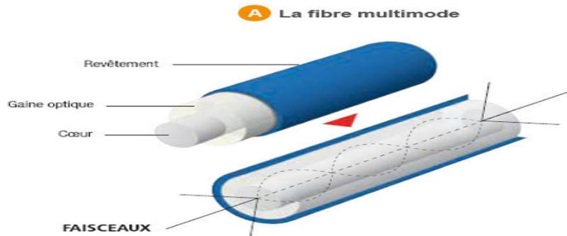
**Figure I.12 :** caractère d'une fibre multi-mode.
