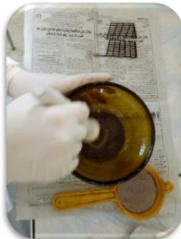
Séchage, broyage et tamisage
