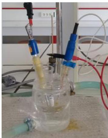
*Figure II.2: Cellule électrochimique à trois électrodes.*
