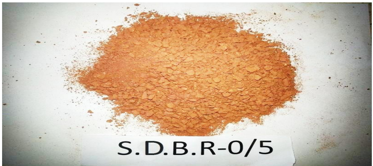
Photo III.4 : Sable recyclé (SDBR) 0/5 produits par le concassage des déchets de briques.
