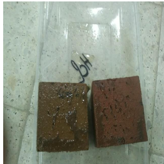
Photo.II.1 : Les éprouvettes dans les milieux agressifs \text{HCl} , \text{H}_2\text{SO}_4 après 28 jours.
