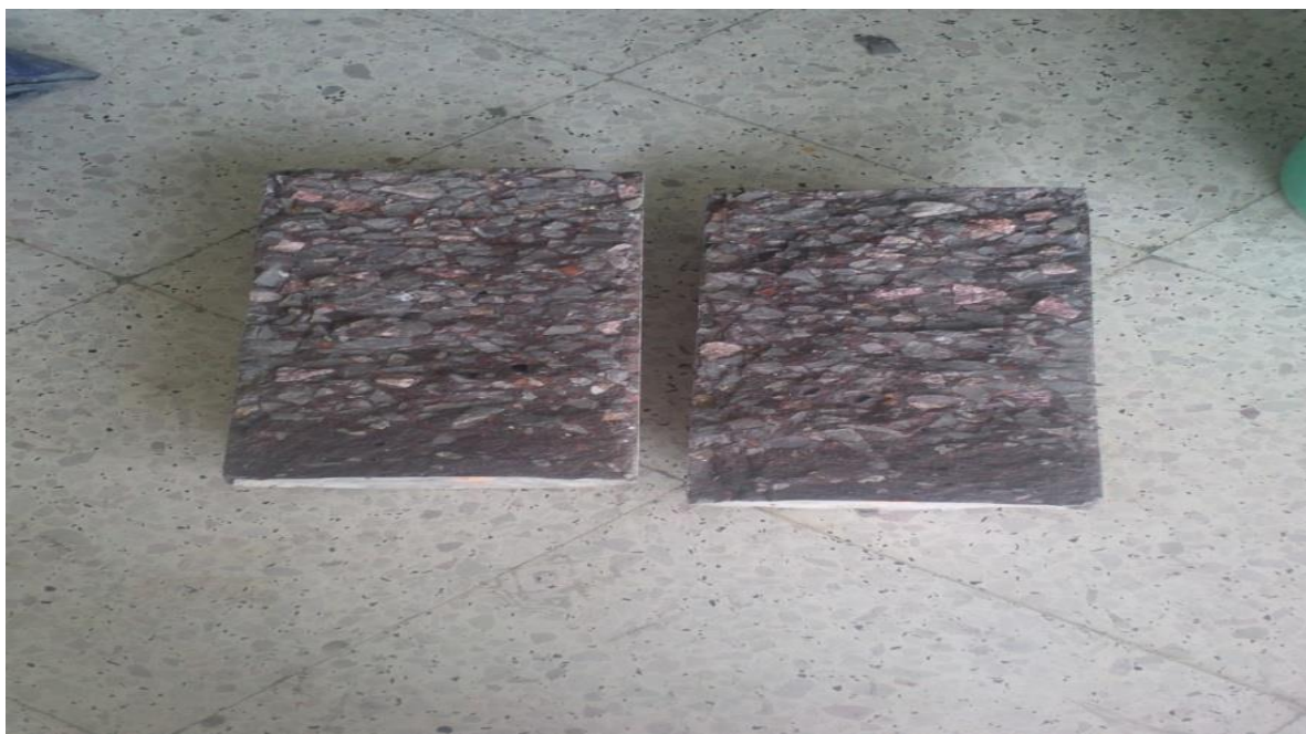
Photo IV.12: Rupture des éprouvettes " l'essai brésilien".
