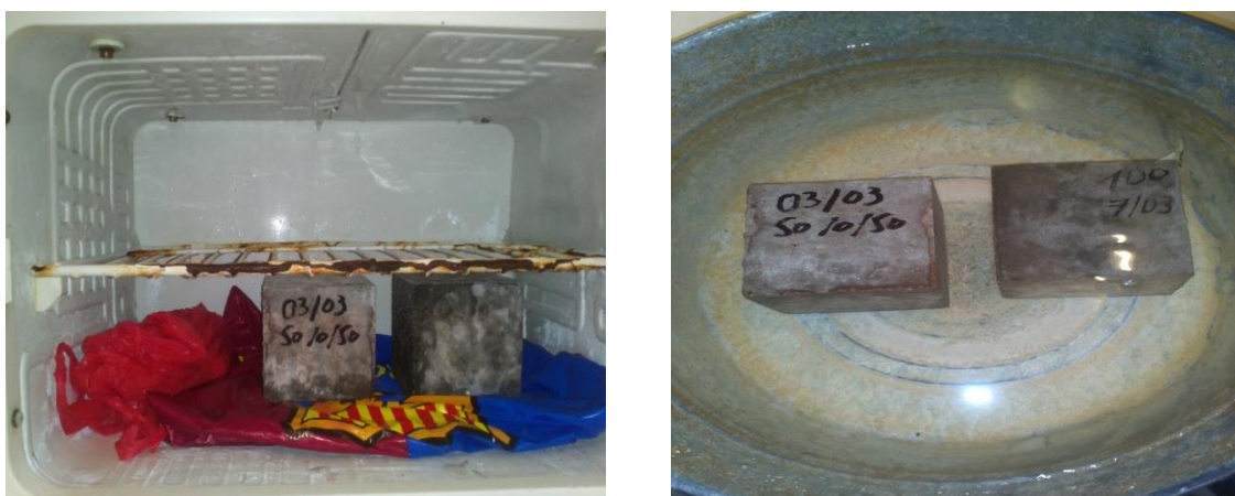
Photo IV.11 : l'essai de gel –dégel.
