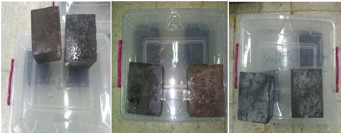
Photo II.2 : Les éprouvette dans les solutions basiques (NaOH, Na_2SO_4 , Sulfate d'alumine) après 28 jours.
