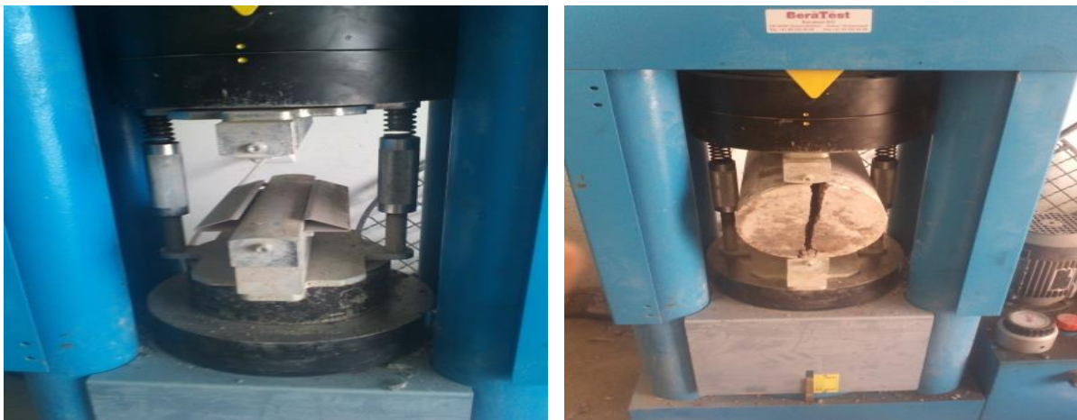
Photo III.9: Appareil de traction par fendage.
