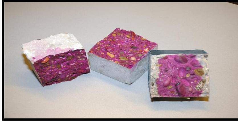
**Figure 1.9 :** *Détermination de la profondeur de carbonatation* [53].
