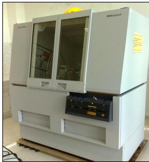
**Figure 2.3 :** *Diffractomètre.*
