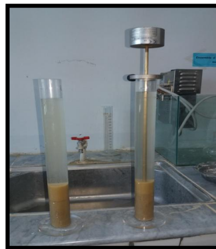
Figure .IV.3 : Essai d'équivalent de sable. Photo IV.12 : Essai d'équivalent de sable.
