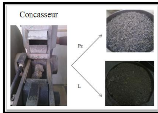
Photo IV.7: Concassage des ajouts (pouzzolane, laitier).
