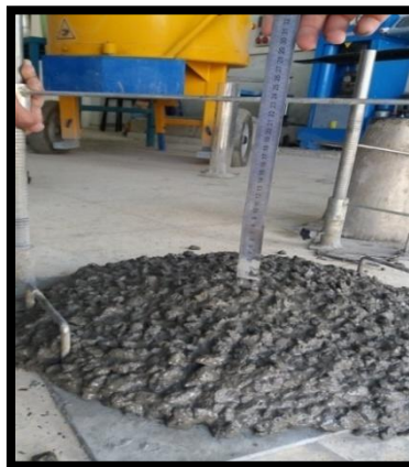
Photo IV.17 : L'affaissement avec le cône d'abrams.
