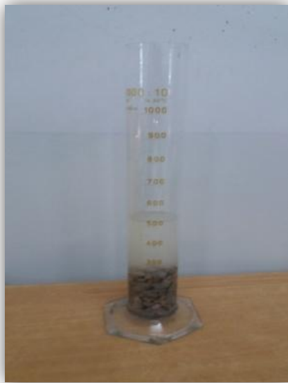
Photo IV.15 : L'essai de la masse volumique apparente de gravier.
