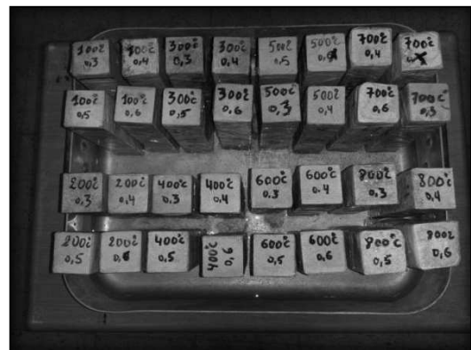
Figure 2.19. Dispositif expérimental de l'essai d'absorption capillaire.
