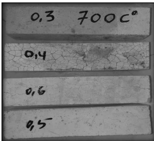
Figure 3.5: Microfissurations des mortiers au delà de 700°C.
