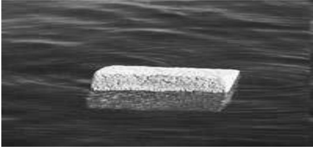
**Figure II.27 : Légèreté d'un béton cellulaire**
