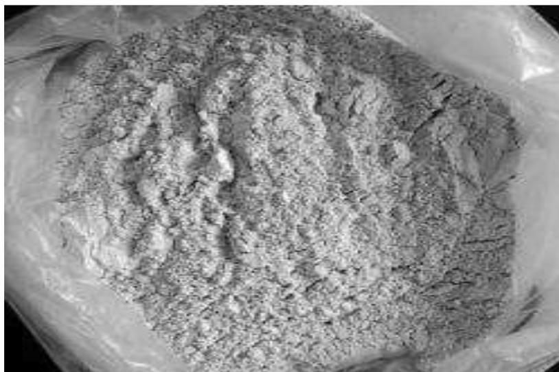
**Figure III.1 :** Le laitier de haut fourneau
