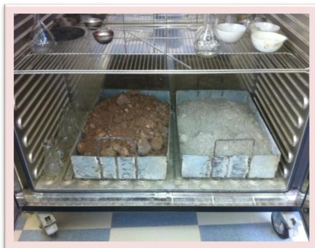
**Photo (III.1) :** *étuve de la cimenterie pour séchage de laitier.*
