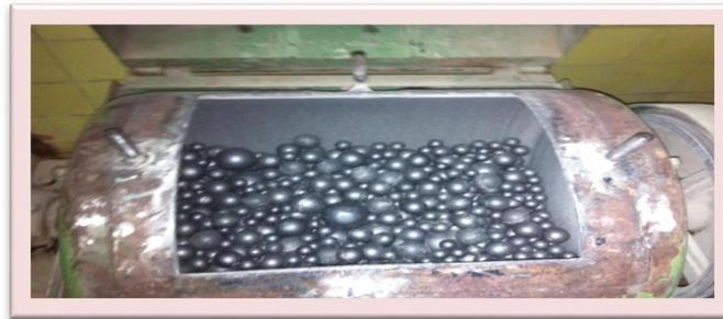
**Photo (III.2) :** broyeur à boulet de 5 kg.
