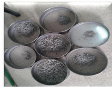
**Figure IV.2 :** *Fraction du gravier après tamisât.*
