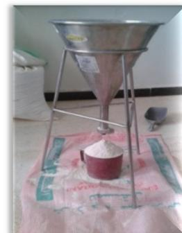
**Figure IV.10 : Entonnoir utilisé.**
