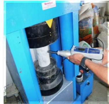
**Figure IV.19** : Mesurer la dureté superficielle du béton.
