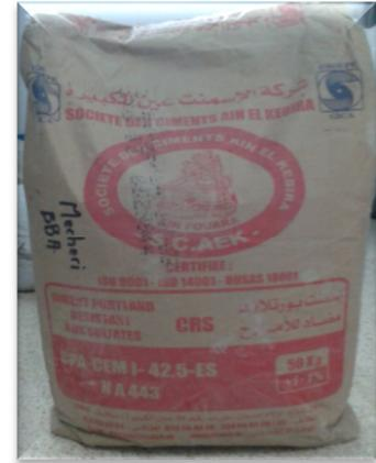
Figure IV.13 : Ciment utilisé CEMI/42,5.
