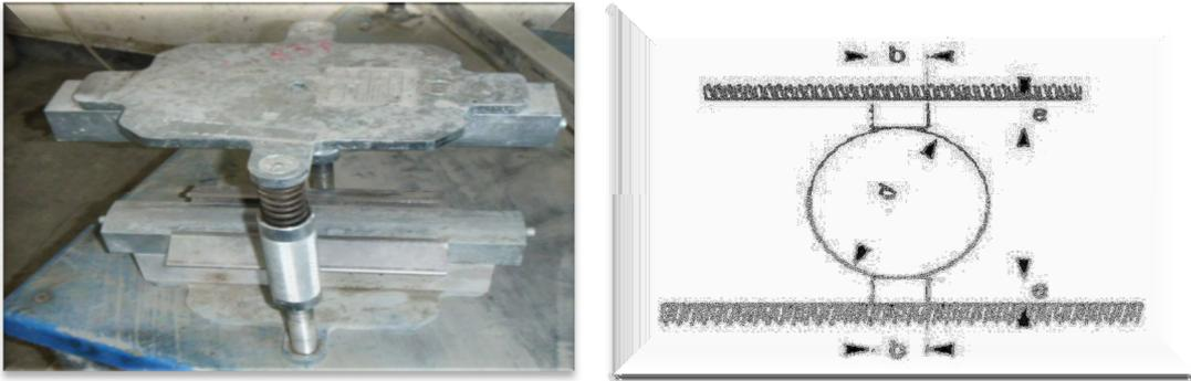
**Figure IV.23 :** *Disposition de mise en charge de l'éprouvette cylindrique pour l'essai de fendage [3].*
