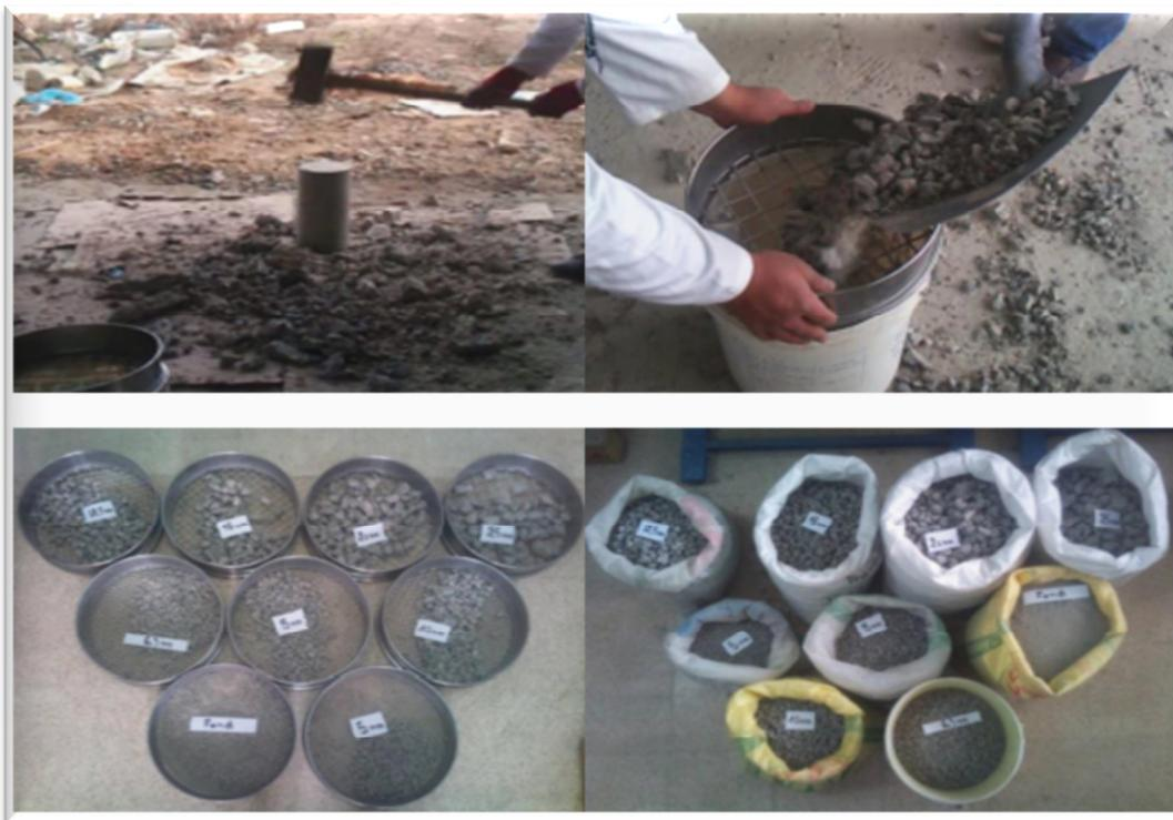
Figure IV.4 : Concassage, tamisage et séparation des agrégats recyclés [80].
