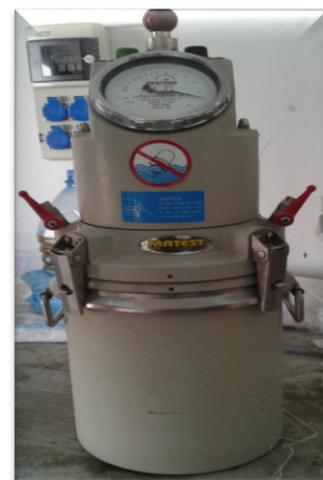
**Figure IV.17 :** *Aéromètre.*
