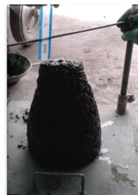
**Figure IV.16 :** Mesure l'affaissement du béton.
