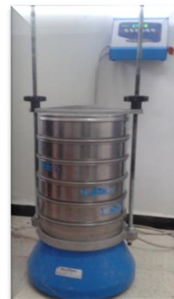
Figure IV. 1 : La tamiseuse utilisée.
