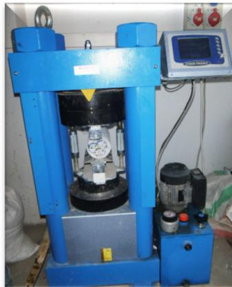
**Figure IV.24 :** *Essai de traction par fendage.*
