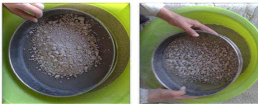
Figure IV.8 : Tamisage de gravier concassé et recyclé avec un tamis 1.6 mm.
