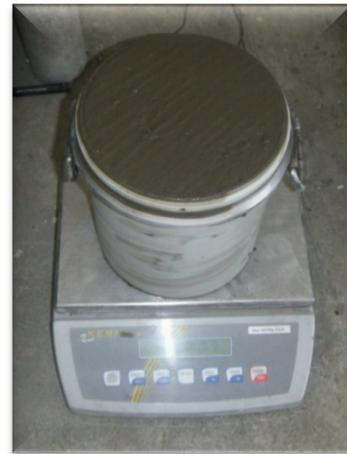
**Figure IV.18 :** *Mesure de la densité du béton à l'état frais.*
