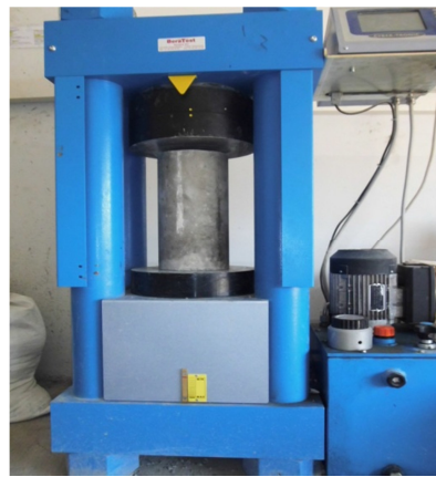
Figure 8.I.2 : Presse hydraulique (BeraTest ) capacité 3000 KN.
