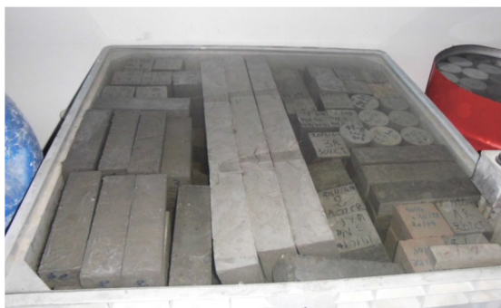
Figure 8.III.2: Murissement des poutres
