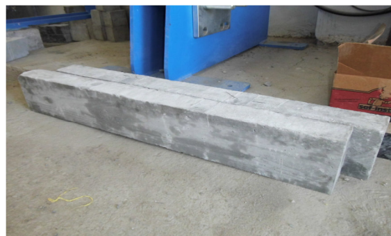
Figure 9.III.2: poutre après 28 jours dans l'eau
