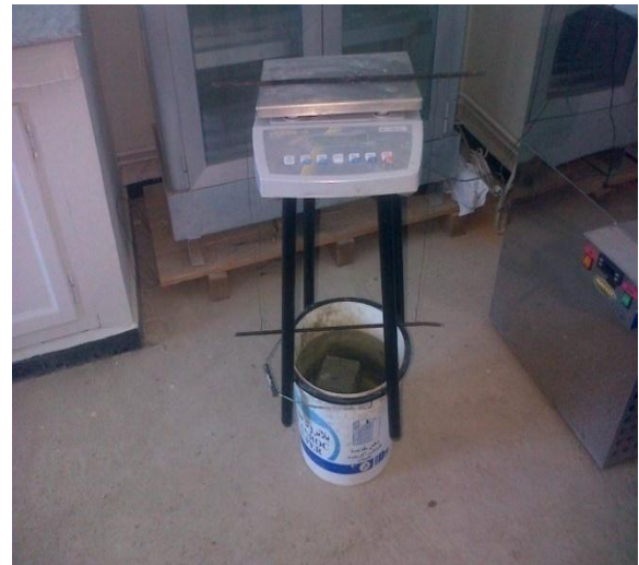
Figure III.13 : la pesée hydrostatique des éprouvettes
