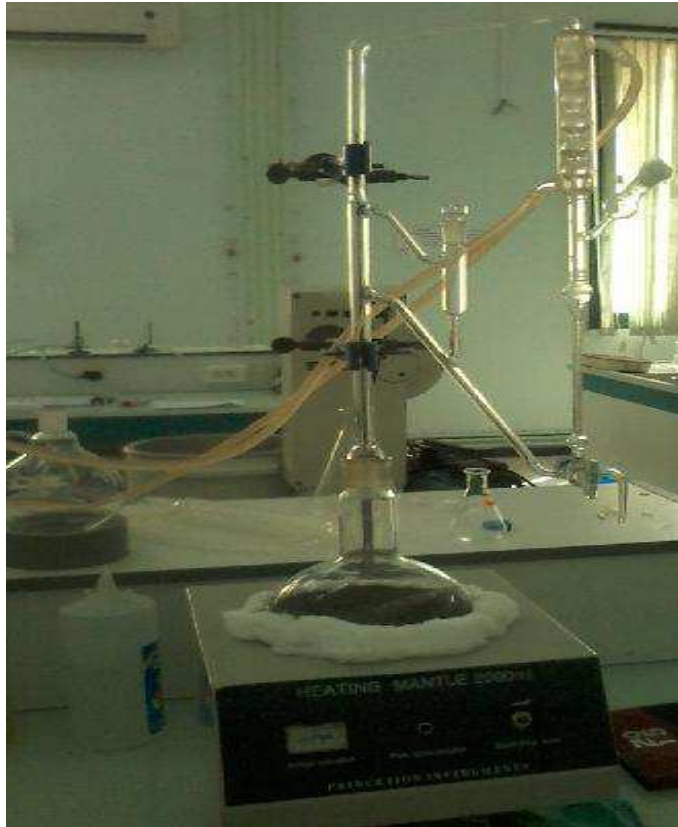
Figure II.3. Dispositif d'extraction par hydrodistillation des huiles essentielles à l'aide d'un appareil de type Clevenger (PERSONNELLE, 2015).
