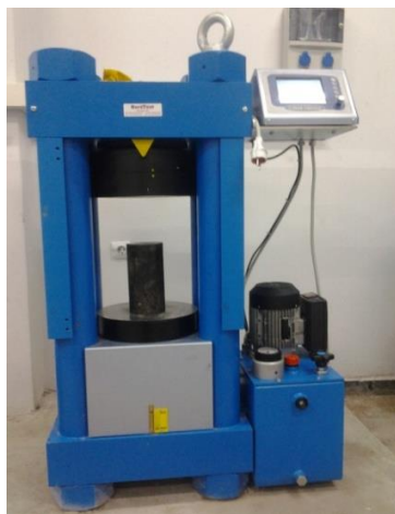
Figure IV.11: Presse hydraulique capacité 3000 KN.
