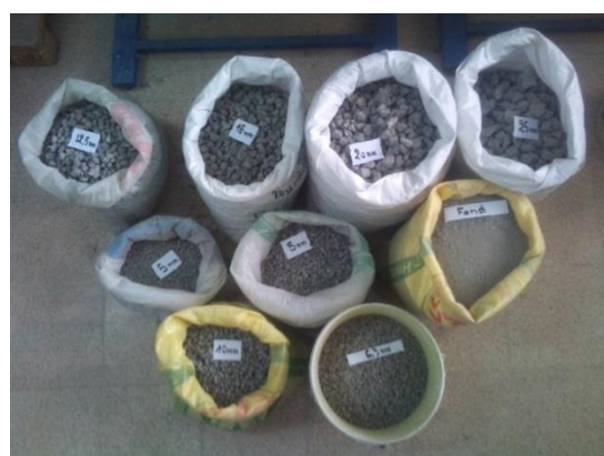
Figure IV.3 : concassage, criblage, tamisage et séparation des agrégats recyclés.
