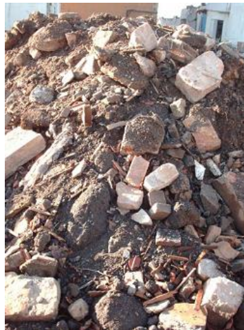
Figure III.3 : Stock de matériaux démolition destiné au recyclage.
