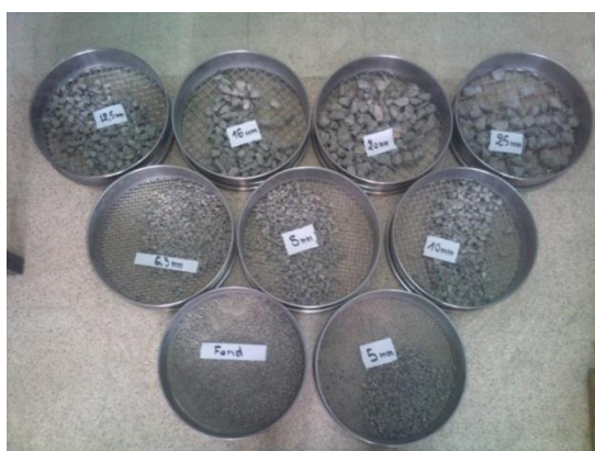
Figure IV.3 : concassage, criblage, tamisage et séparation des agrégats recyclés.
