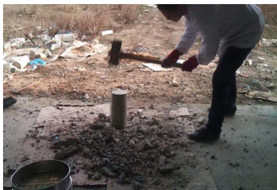
Figure IV.2 : Procédure de préparation des granulats recyclés.
