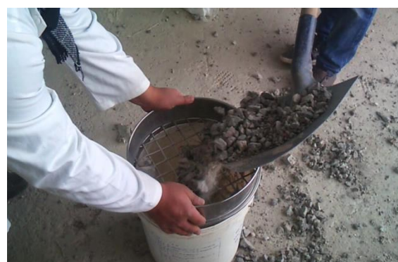
Figure IV.2 : Procédure de préparation des granulats recyclés.
