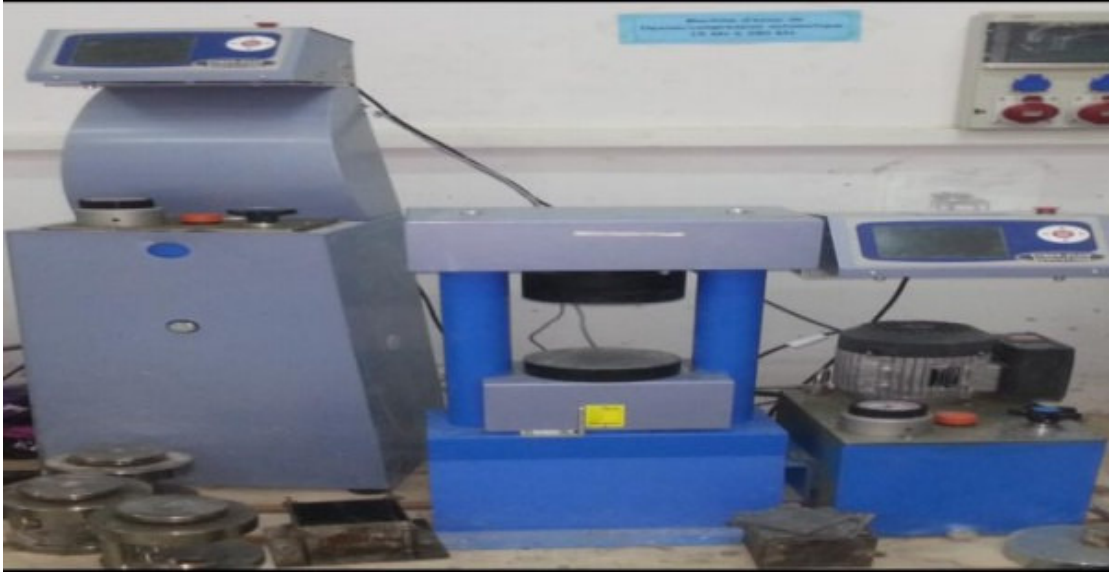
Photos III.6 : Presse hydraulique pour mortier de 15 à 250 KN
