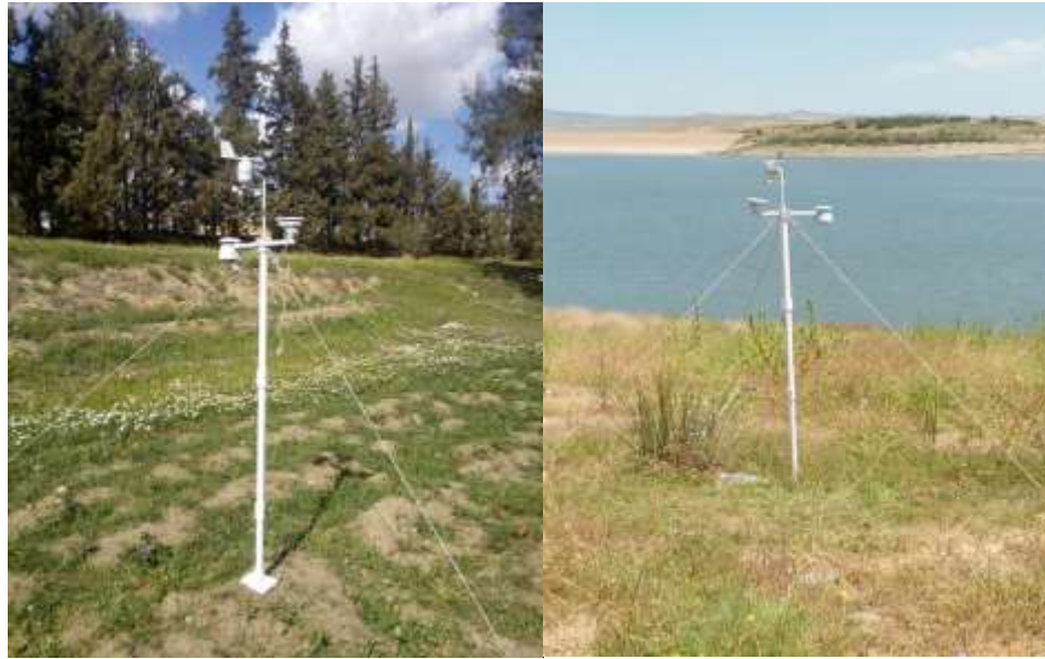
Figure 14 : Station météo sans fil. (Photographie Original, 2018).
