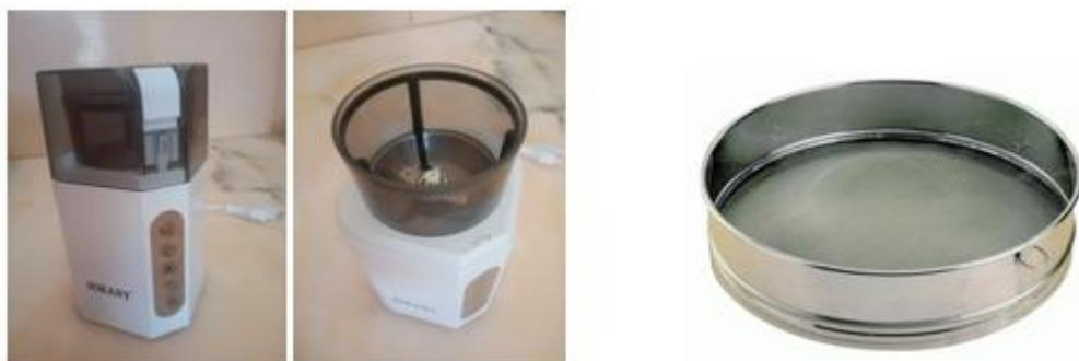
**Figure 14** : Photographie du broyeur électrique et du tamiseur manuel (250  $\mu$ m)
