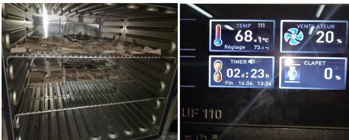
**Figure 11 :** Séchage sous étuve type Memmert (Original)
