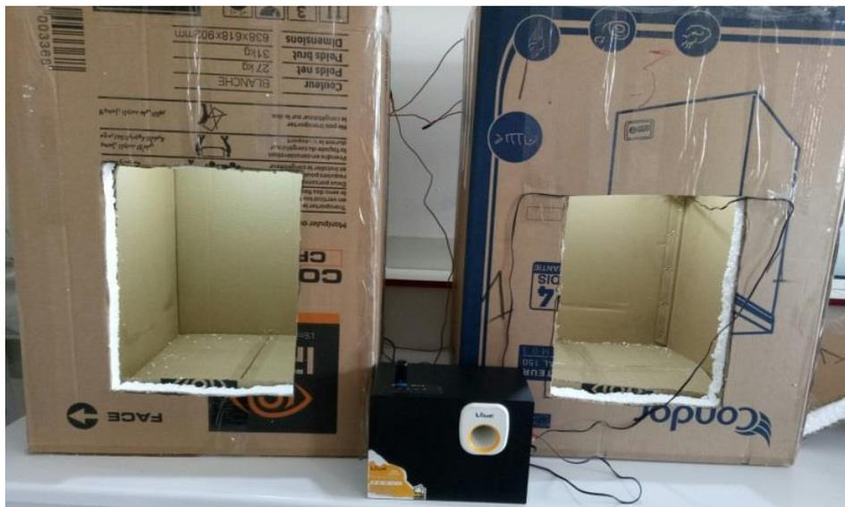
**Figure 05 :** Boîtes utilisées pour l'isolation sonore
